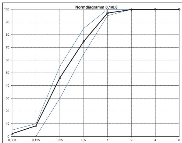
Quarzsand RK I 0,1/0,8 gewaschen ist ein durch moderne Aufbereitungstechnologie hergestellter natürlicher Rohstoff. Die laufende Eigen- und Fremdüberwachung nach vorgeschriebenen Verfahrensanweisungen garantiert eine hohe und gleichmäßige Qualität.
